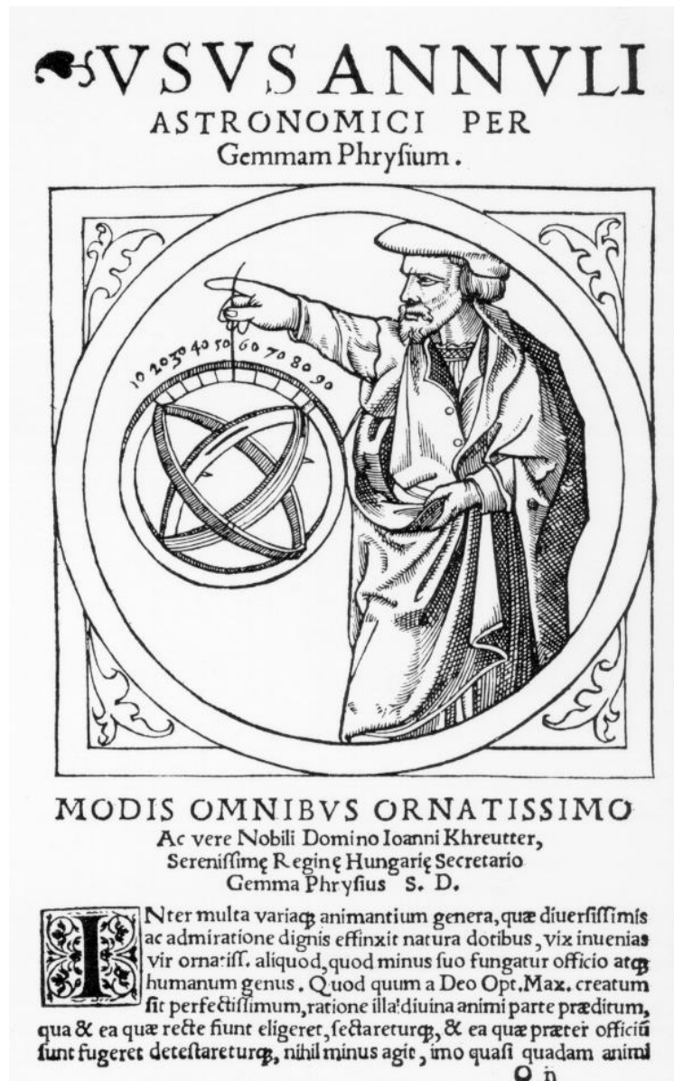
Figura 1.24. Gli anelli astronomici di Gemma Frisius. “Uno strumento equatoriale portatile che poteva essere utilizzato a qualsiasi latitudine... per il cronometraccio del sole, come pure per molte altre osservazioni astronomiche approssimative (Apiano, 1539). Preso da [1029], pagina 21.
